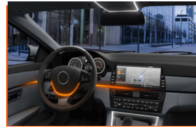
ALS for automatic display brightness control (SFH 5711/SFH 5701 A01, SFH 2770 A01)
